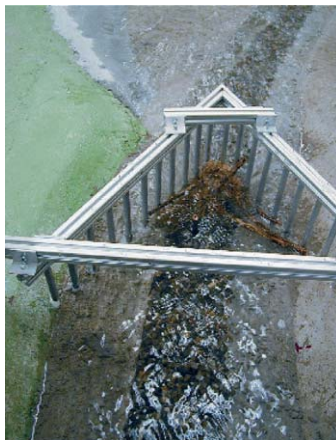
Abb. 10: Versuch mit einem V-förmigen Grobrechen. Fig. 10: Tests with a V-formed grill.
