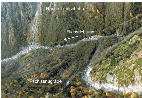
Abb3: Vertikal Aufnahme mit ausgeräumtem Gerinne des Pschissnugrabe und der Runse Tuntschetta, deren Schuttkegel abgeräumt wurde Fig3: Vertical view of the channel of Pschissnugrabe cleared by the event, and the gully Tuntschetta, whose debris fan has been eroded
