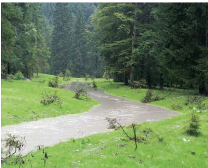
Abb. 5-6: Die Ausleitungsmulde während des Flutungsversuches. Links bei steigendem Wasserspiegel, rechts bei Vollfüllung und beginnendem Abfluss über die talseitige Abflusskante.
