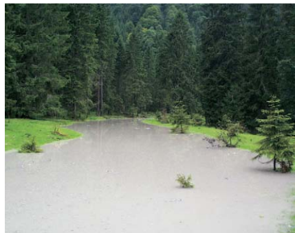
Abb. 5-6: Die Ausleitungsmulde während des Flutungsversuches. Links bei steigendem Wasserspiegel, rechts bei Vollfüllung und beginnendem Abfluss über die talseitige Abflusskante.
