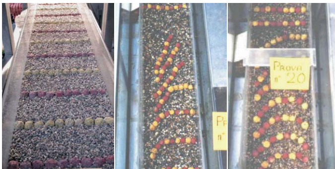
Fig. 9: Modalità di collasso delle rampe in massi legati: la configurazione iniziale (a sinistra) e due esempi di collasso ( R = 20\% , al centro; R = 40\% a destra).
