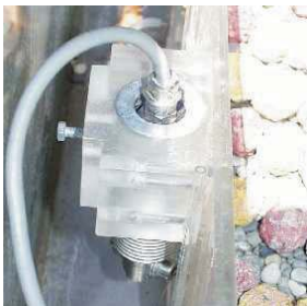
Fig. 5: Vista laterale del sistema di montaggio della cella di carico.
