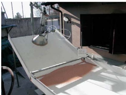
Fig. 4: Apparato sperimentale per le prove su piano inclinato.
