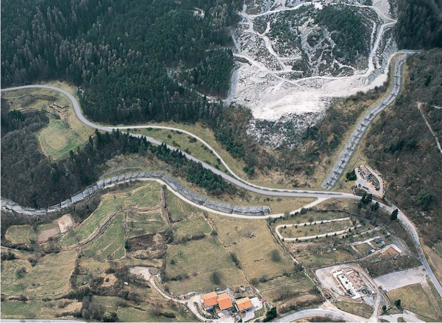
Fig. 9: Inserimento del nuovo alveo del torrente Magnone e della rettifica della strada provinciale. Fig. 9: Rendering with the modified location of Magnone river and road.
