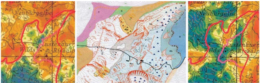
Abb7: Elektromagnetik Daten: links an der Oberfläche; rechts in rd. 43 m Tiefe unter GOK Fig7: Electromagnetic data: left: on the surface; right: 43m sub-surface
