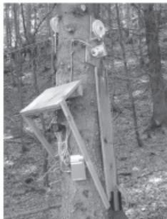
Abb. 11: Blick auf die Seilextensometer mit automatische Messwerterfassung über Wegaufnehmer und Datensammler
