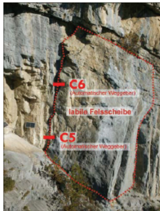
Abb. 2: Labile Felscheibe (rund 1'000 m 3 ) am Brünigpass über der Nationalstrasse N 8 (Kt. Bern, Schweiz) mit Lage der automatischen Weggeber C5 und C6
