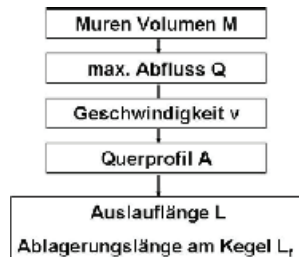
Abb. 1: Parameter zur Abschätzung potentieller Reichweiten von Muren (aus Rickenmann, 1999).
