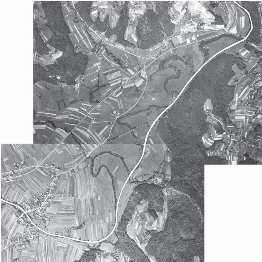
Abb.2: Mäandrierender Verlauf der Sulm flussab Heimschuh 1952, Verlauf der regulierten Sulm 1998 (weiße Linie), Bildquelle: BEV Wien
