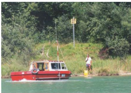
Abb. 2: Stauraumlotung mittels Echolotboot
