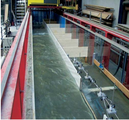
Fig. 4: Vue depuis l'amont du canal avec le déversoir latéral
