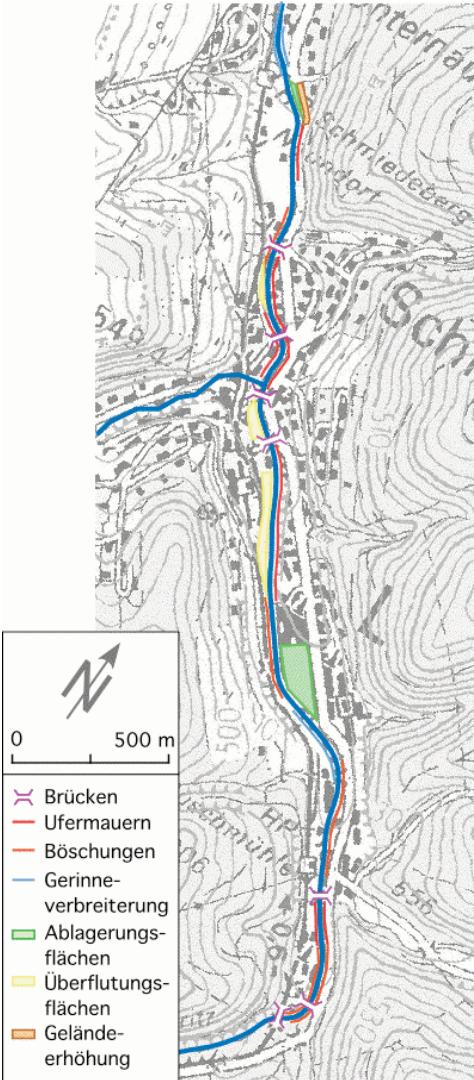
Abb. 5: Übersicht über die wichtigsten Hochwasserschutzmaßnahmen in Schmiedeberg.
