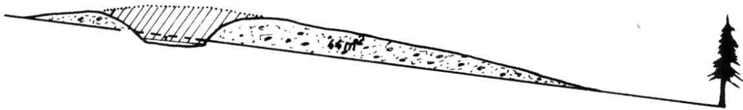
Fig. 2. Flat cross-section of spreading and overflowing debris flow (Aulitzky 1970) Flache Form der (im Bogen) abfließenden, langsamen Mure, bei der bereits die Ausbreitungstendenz überwiegt (Aulitzky 1970)
